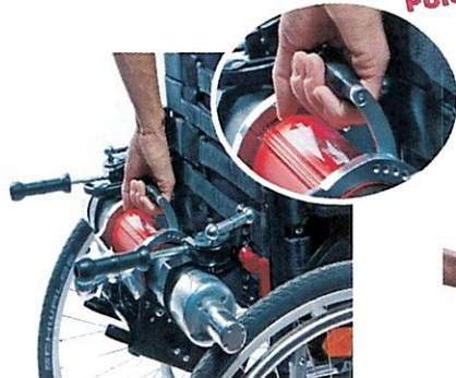
Poser la motorisation sur les crochets rouges du fauteuil
