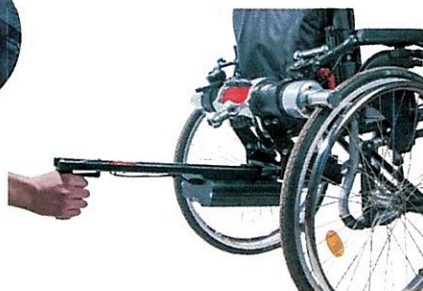
Glisser la batterie sur la motorisation la connexion est automatique
